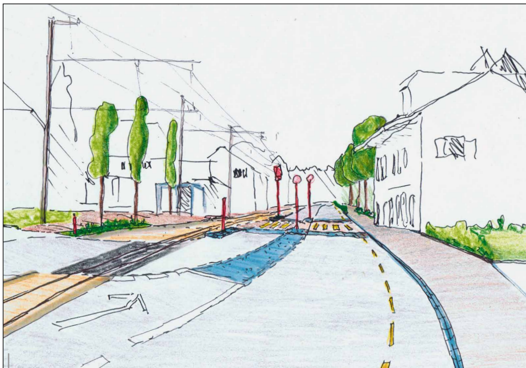
Punktueller Querung: wunschliniengerecht, optisch betont, mit Insel versehen.
